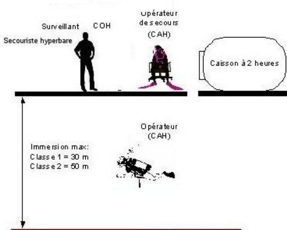
Fig. 5 : Composition d'une équipe minimale pour une plongée au narguilé à partir de la surface
